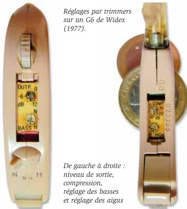
*De gauche à droite : niveau de sortie, compression, réglage des basses et réglage des aigus*
