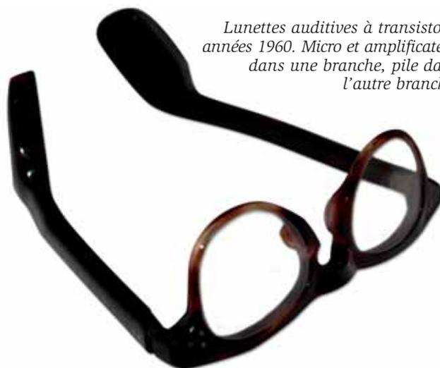
*Lunettes auditives à transistors, années 1960. Micro et amplificateur dans une branche, pile dans l'autre branche.*
